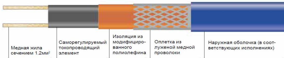
Рис. №1 – конструкция саморегулирующейся нагревательной ленты HLR
